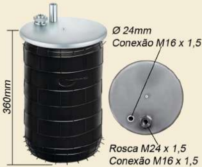
MOLA PNEUMÁTICA AXOR / ACTROS (S/Base - C/Sensor) N° Original 9583200421 Cód. 2123m Cód. 2121m - Base
