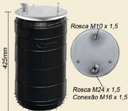
MOLA PNEUMÁTICA EIXO VOLVO FH a partir 2016 S/ Base - Ø 275mm (Maior) Nº Original 21224745 / 22058737 Cód. 2118v Cód. 2114v - Base
