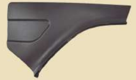
ACABAMENTO SUPERIOR PARALAMA SCANIA S4 R (Traseiro) Nº Original 1364666 Cód. 657s - LD Nº Original 1364665 Cód. 656s - LE
