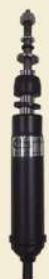
AMORT. CABINE SCANIA S4/S5 R (Dianteiro / Parafuso 12mm) a partir 1998 Nº Original 1363122 / 1424228 Cód. 843s
