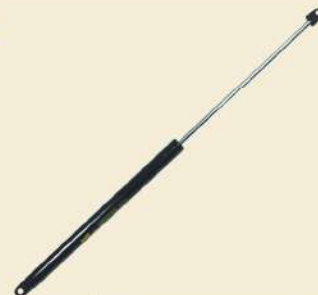
MOLA GÁS GRADE SUPERIOR SCANIA S5 G/R/HIGHLINE a partir de 2008 Comprimento: 406mm - 692mm Carga: 420N - 42 Kgf N° Original 1481371 / 1435542 Cód. 1328s
