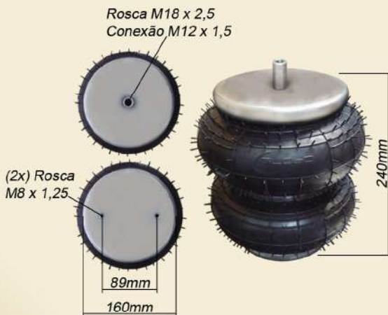
FOLE SUSPENSOR EIXO DIRECIONAL KLL N° Firestone 950554 N° Contitech FD20022792 / 67972 N° KLL 8035228B01 Cód. 2077cr
