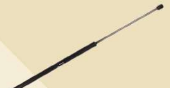
MOLA GÁS GRADE VOLVO VM Comprimento: 430 - 693mm Carga: 260N - 26Kgf Nº Original 20491669 Cód. 1560v
